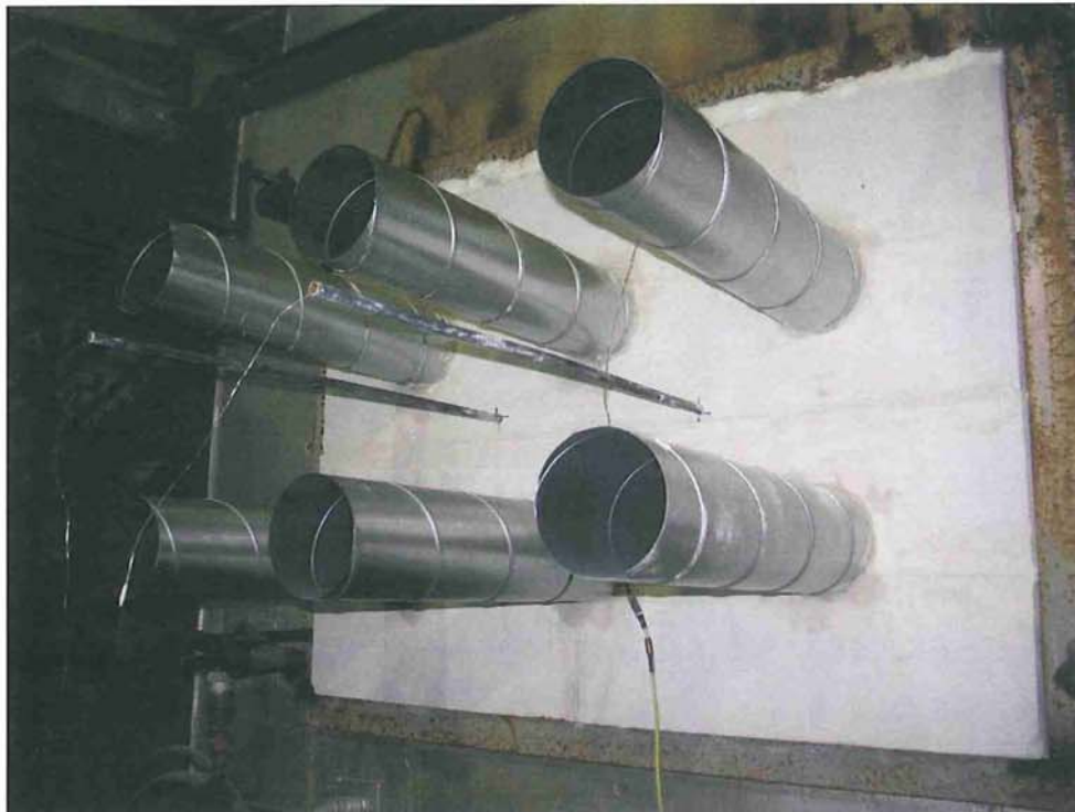
Kuva 2. Seinään asennetut koekappaleet ulkopuolelta ennen palonkestävyyskoetta.
