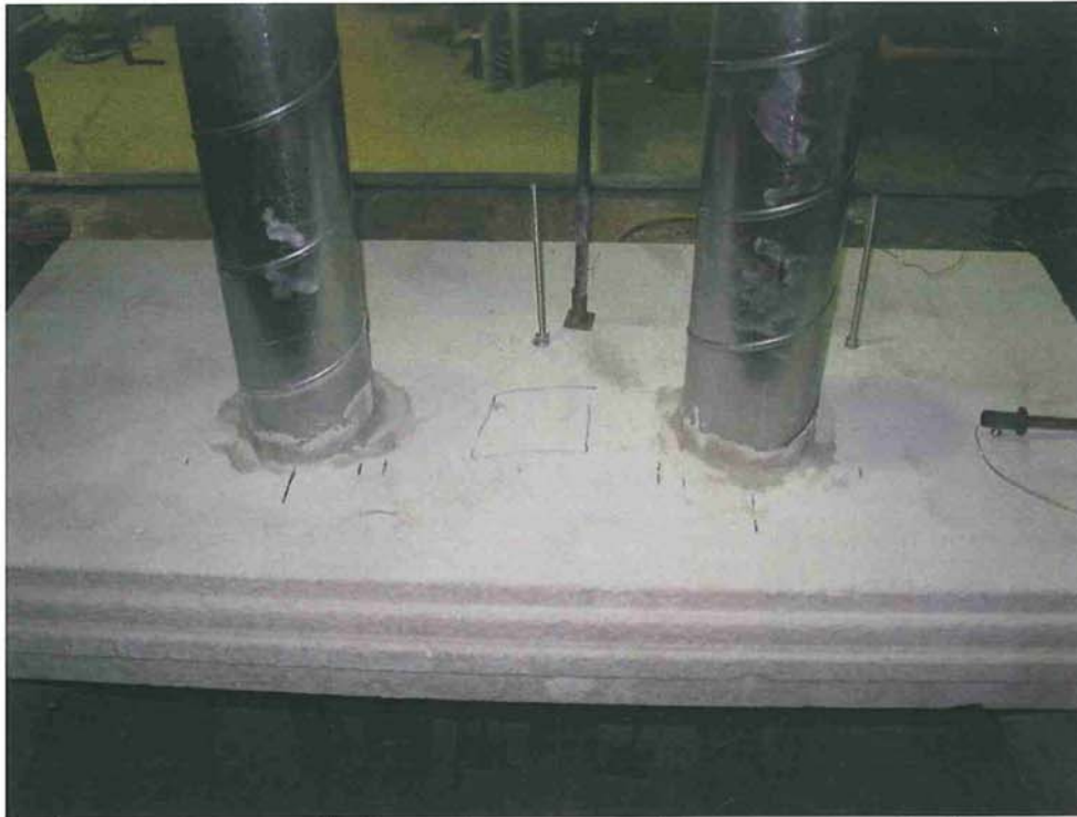
Kuva 3. Laattaan asennetut koekappaleet asennusvaiheessa ennen palonkestävyyskoetta.
