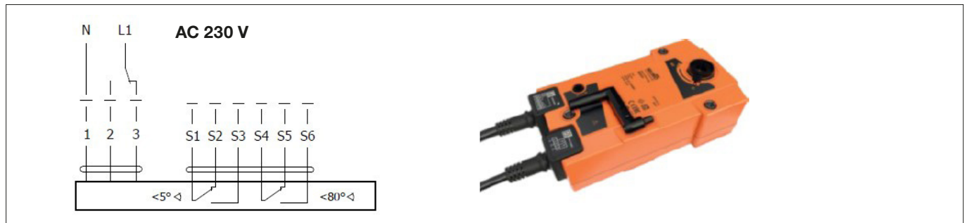
Kuva 7 Toimilaite BELIMO BEE 230
