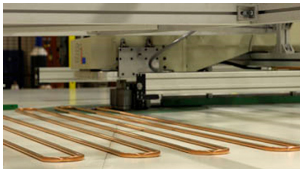
Kuva 2: Atrium Planan huipputarkka laserhitsaus.
