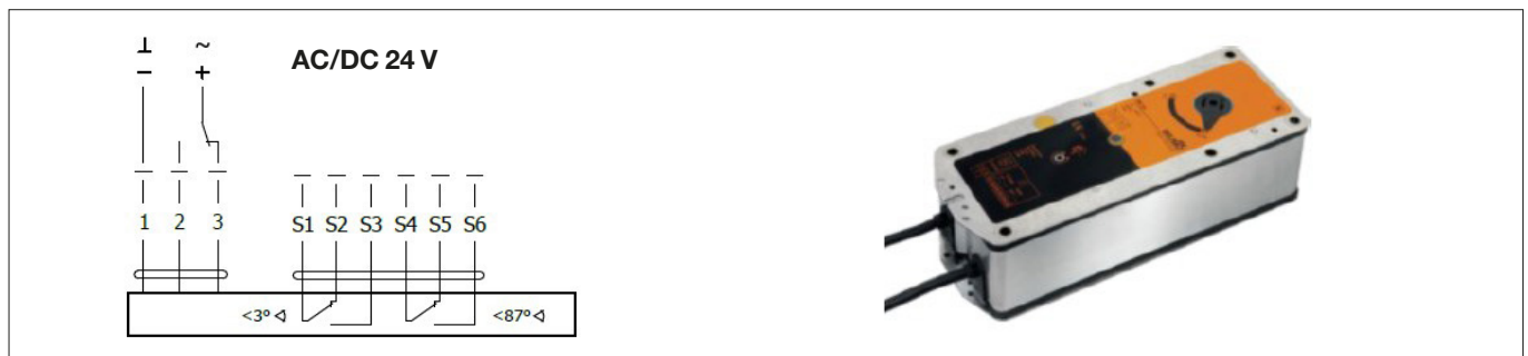
Kuva 8 Toimilaite BELIMO BE 24-12(-ST)
