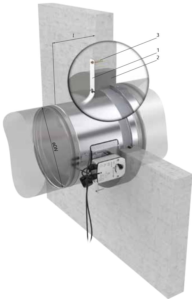
Kuva 5: Pyöreän palopellin PKIR märkäasennus kipsillä tiili- tai betoniseinään
