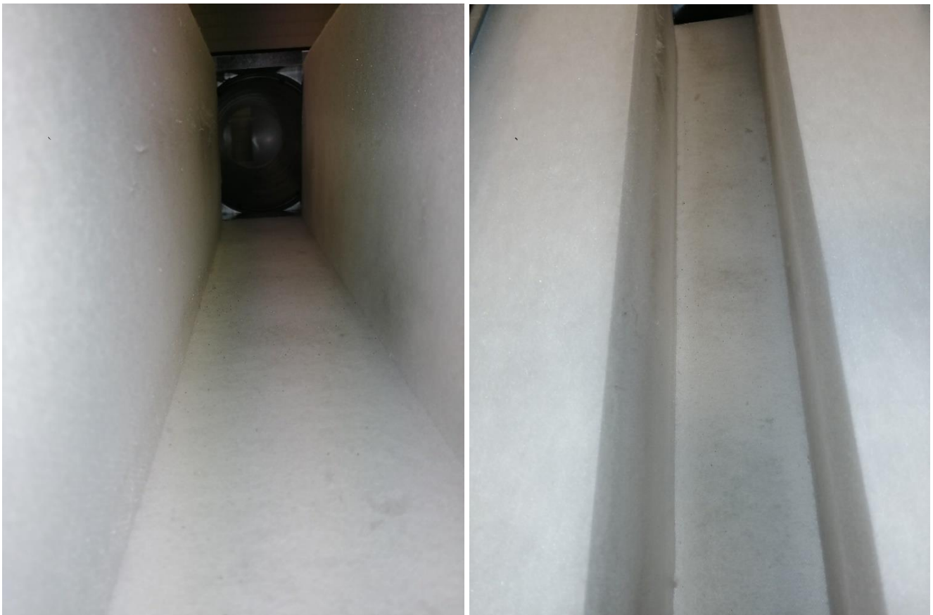
Kuva 12. Suora kanava: 1 harjaus teräsharjalla: KVDPX-4 nro1.
