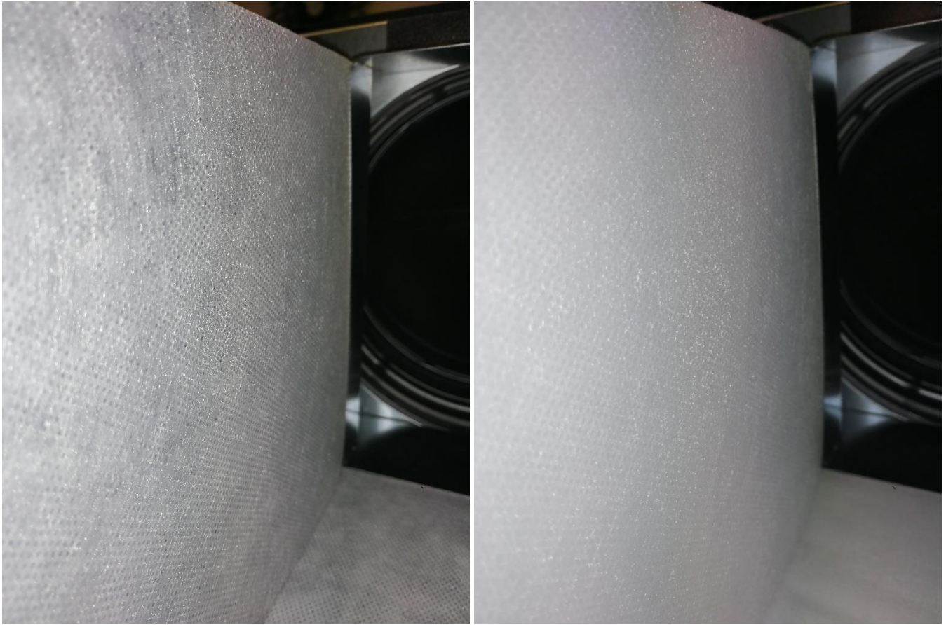
Kuva 9. 90° mutka: 5 harjausta: KVDPX-2 nro2 ja KVDPX-4 nro2.
