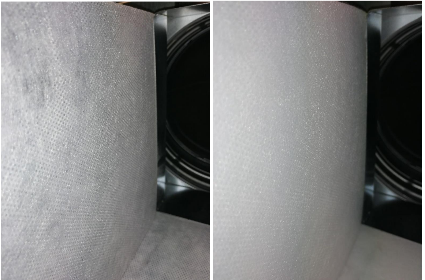
Kuva 11. 90° mutka: 20 harjausta: KVDPX-2 nro2 ja KVDPX-4 nro2.
